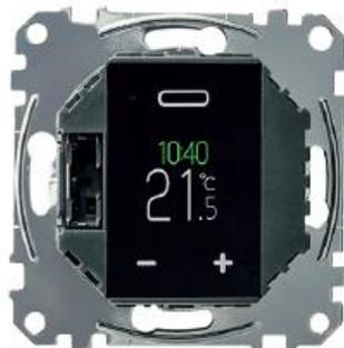
Центральная плата для механизма универсального терморегулятора с сенсорным дисплеем
